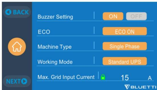
Il existe au total quatre modes de fonctionnement que vous pouvez sélectionner dans les paramètres: **Mode UPS standard:** mode de fonctionnement par défaut (mode hors ligne).
